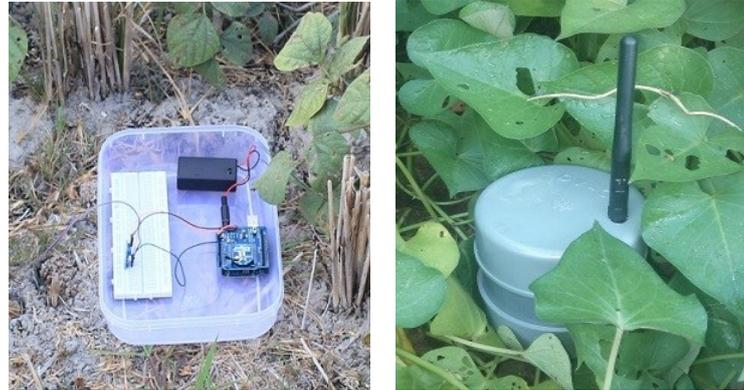
Gambar 1. Prototip node sensor di lahan pertanian
